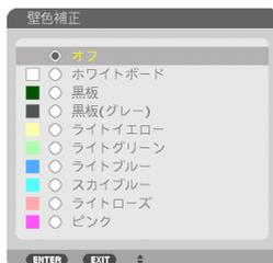
映像を投写する面がスクリーンではなく、部屋の壁などの場合、メニューから壁の色に近い項目を選択すると、壁の色に適応した色合いに補正して投写できます。
