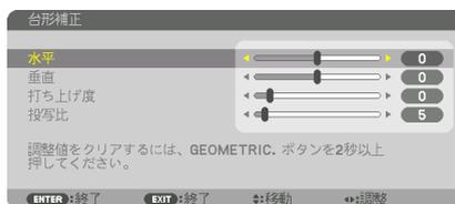
投写画面の水平方向と垂直方向の台形歪みを調整します。
