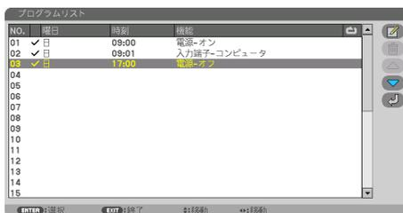
曜日や時刻を設定することにより、本機の電源オン／スタンバイや映像信号の切り替え、およびエコモードの切り替えを自動で行うことができます。たとえば、上の画面の設定では、日曜日の9時に電源がオンになり、9時1分にコンピューターの画面に切り替わり、17時に電源がスタンバイ状態になります。
