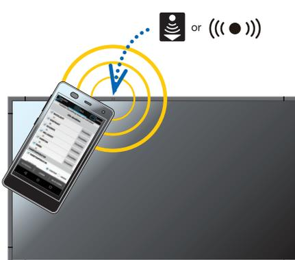
Um einen Anpassungs-/Einstellwert des Displays zu lesen/schreiben, bringen Sie das Endgerät nahe zum Sensor für Intelligent Wireless Data des Displays und drücken Sie die Taste LESEN/SCHREIBEN der Anwendung. Oder, bringen Sie das Endgerät nahe zum intelligente Funkdaten-Sensor des Displays, nachdem Sie die Taste LESEN/SCHREIBEN der Anwendung gedrückt haben.
