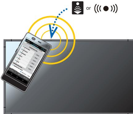
Para leer/escribir un valor de ajuste/valor de configuración de la pantalla, acerque el terminal al Sensor de datos inalámbricos inteligentes de la pantalla y pulse el botón LEER / ESCRIBIR de la aplicación. O, después de pulsar el botón LEER/ESCRIBIR de la aplicación, acerque el terminal al Sensor de datos inalámbricos inteligentes de la pantalla.
