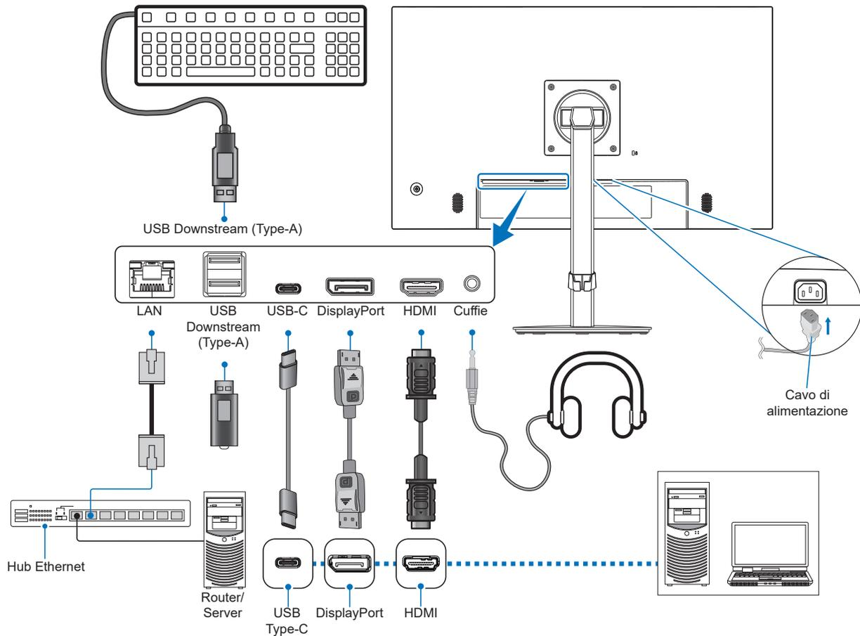
Per garantire la conformità alle normative EMC, utilizzare cavi di segnale schermati per il collegamento ai seguenti terminali: HDMI IN, DisplayPort IN, porta USB a valle (Tipo-A) e porta USB-C®.
