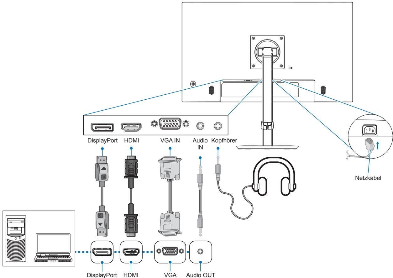
Um die Einhaltung der EMV-Vorschriften einzuhalten, verwenden Sie für den Anschluss an die folgenden Klemmen abgeschirmte Kabel: HDMI IN und DisplayPort IN. Verwenden Sie für den Anschluss an die folgenden Klemmen abgeschirmte Signalkabel: VGA IN.
