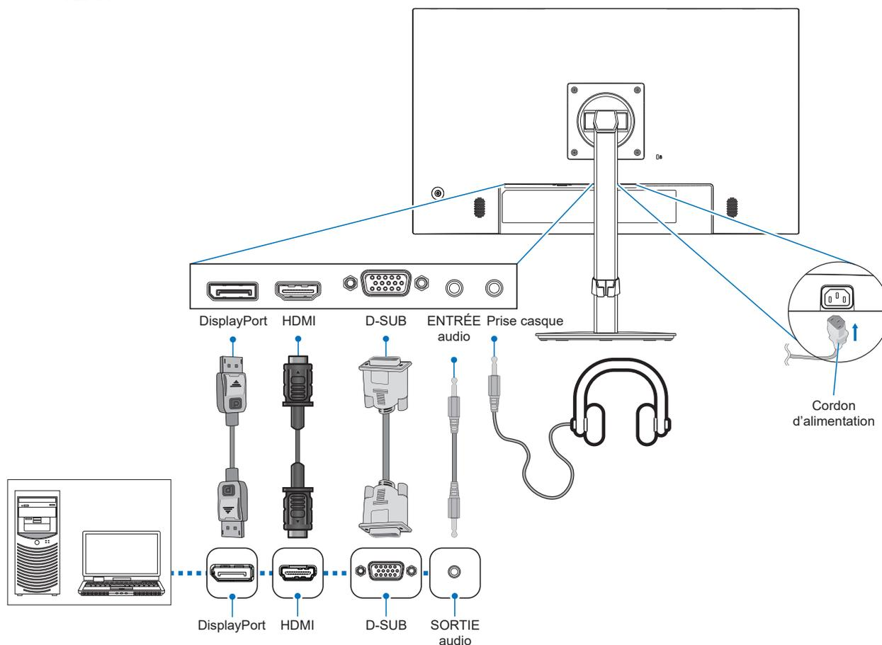
Afin de maintenir la conformité avec les réglementations CEM, utilisez des câbles blindés pour la connexion aux bornes suivantes : HDMI IN et DisplayPort IN. Utilisez des câbles de signal blindés avec noyau de ferrite pour la connexion aux bornes suivantes : VGA IN.
