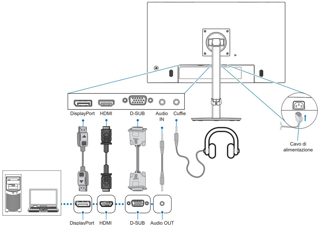
Per garantire la conformità alle normative EMC, utilizzare cavi schermati per il collegamento ai seguenti terminali: HDMI IN e DisplayPort IN. Utilizzare cavi di segnale schermati con nucleo in ferrite per il collegamento ai seguenti terminali: VGA IN.
