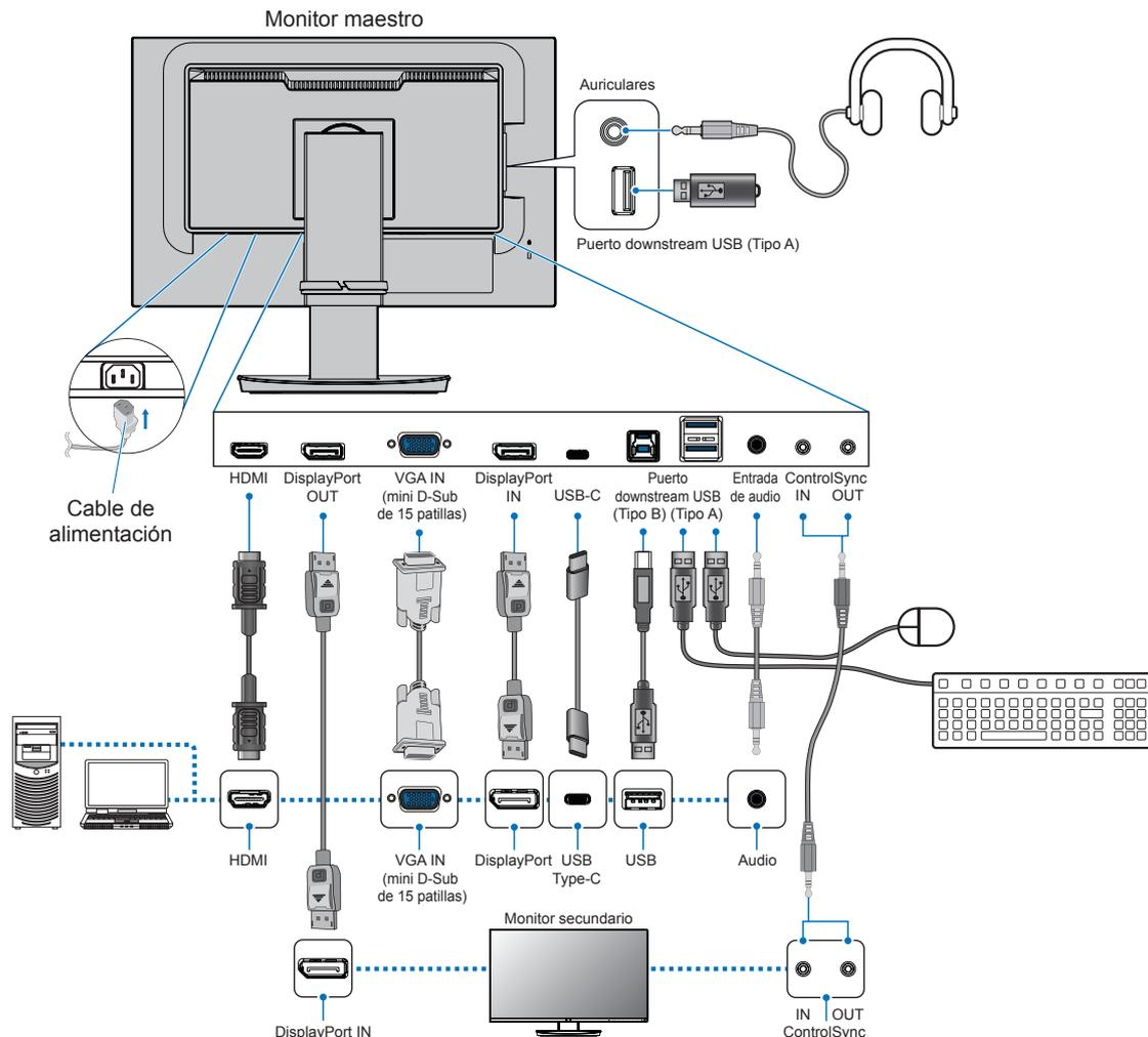
Para cumplir con la normativa de la EMC, utilice cables blindados para la conexión a los siguientes terminales: HDMI IN, DisplayPort IN, Puerto USB Downstream (Tipo A), Puerto USB Upstream (Tipo B), y Puerto USB-C®. Utilice cables de señal blindados con núcleo de ferrita para la conexión a los siguientes terminales: VGA IN.
