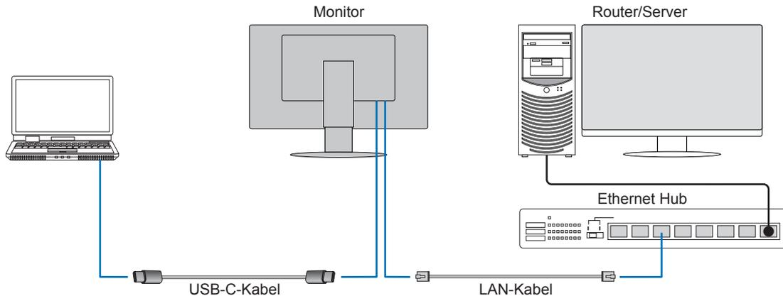
\* Schließen Sie den Monitor über ein USB-C-Kabel oder ein USB-Typ-B-/Typ-A-Kabel an den Computer an.
