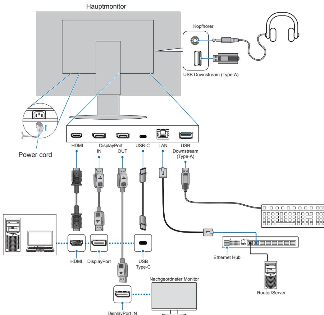
Um die Einhaltung der EMV-Vorschriften einzuhalten, verwenden Sie für den Anschluss an die folgenden Klemmen abgeschirmte Kabel: DisplayPort IN, HDMI IN, USB-Downstream-Anschluss (Typ A) und USB-C®-Anschluss.
