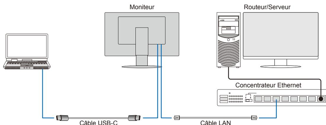
\* Connectez le moniteur à l'ordinateur via un câble USB-C ou un câble USB-Type-B-A.
