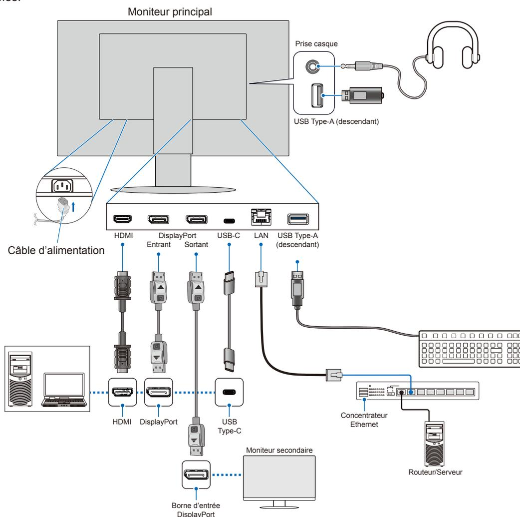
Afin de maintenir la conformité avec les réglementations CEM, utilisez des câbles blindés pour la connexion aux bornes suivantes : DisplayPort IN, HDMI IN, port USB descendant (type A) et port USB-C®.
