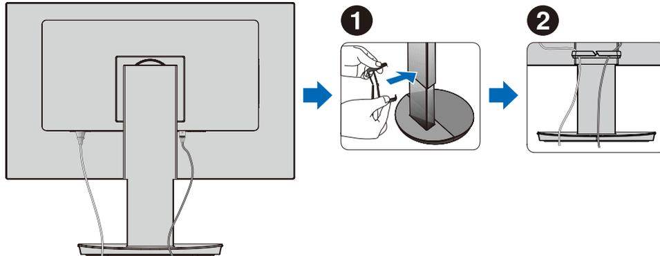
**NOTA:** Controllare che sia ancora possibile ruotare, sollevare e abbassare lo schermo del monitor dopo aver installato i cavi.
