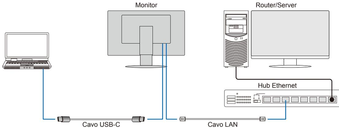
\* Collegare il monitor al computer tramite un cavo USB-C o un cavo USB-Type-B - Type-A.
