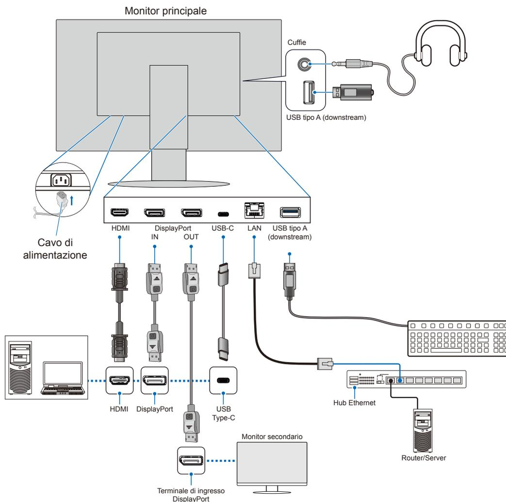
Per garantire la conformità alle normative EMC, utilizzare cavi schermati per il collegamento ai seguenti terminali: DisplayPort IN, HDMI IN, porta USB a valle (Tipo-A) e porta USB-C®.
