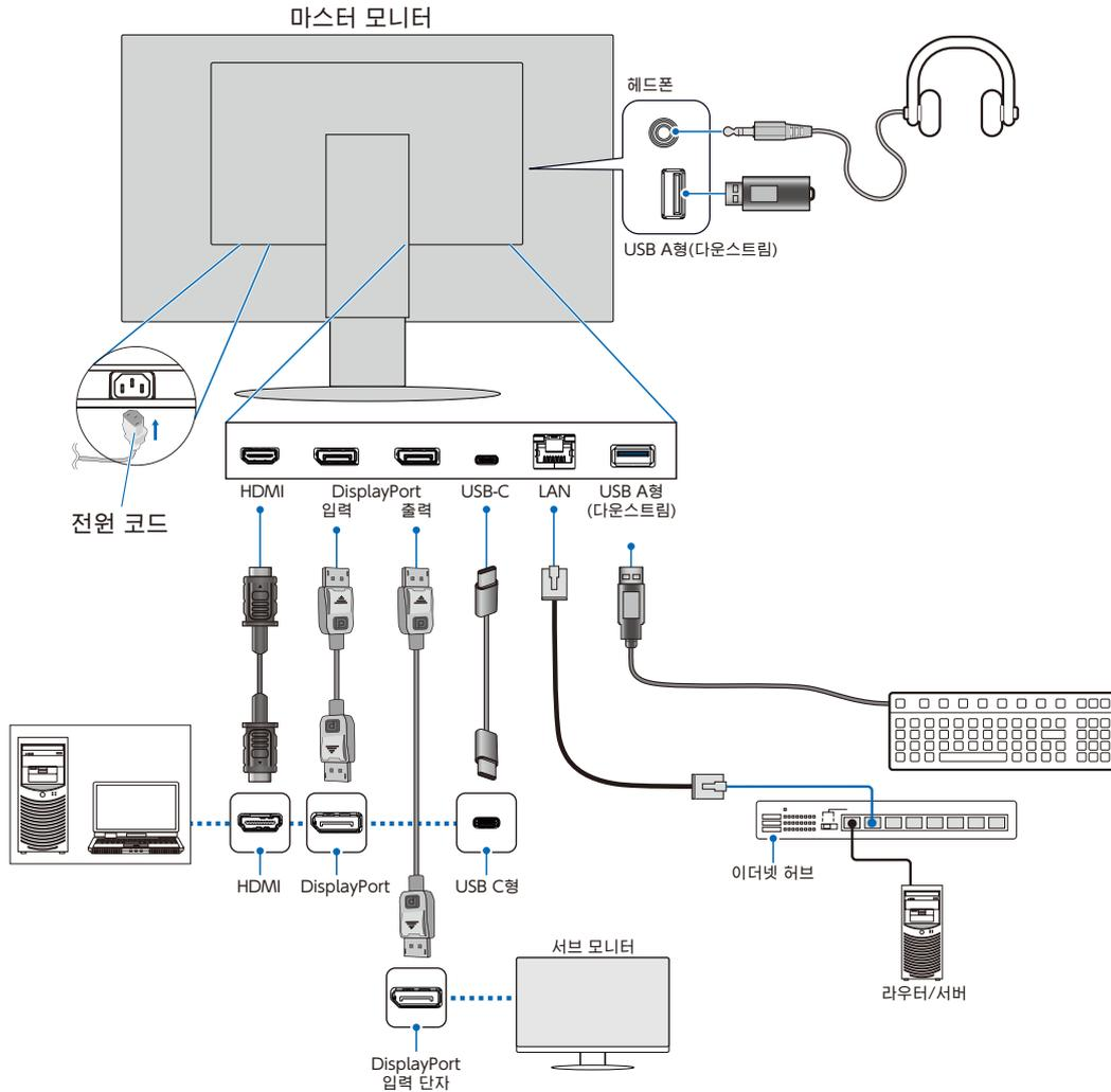
EMC 규정을 준수하려면 차폐 케이블을 사용하여 다음 단자에 연결하십시오: DisplayPort IN(DisplayPort 입력), HDMI IN(HDMI 입력), USB 다운스트림 포트(A타입) 및 USB-C® 포트.
