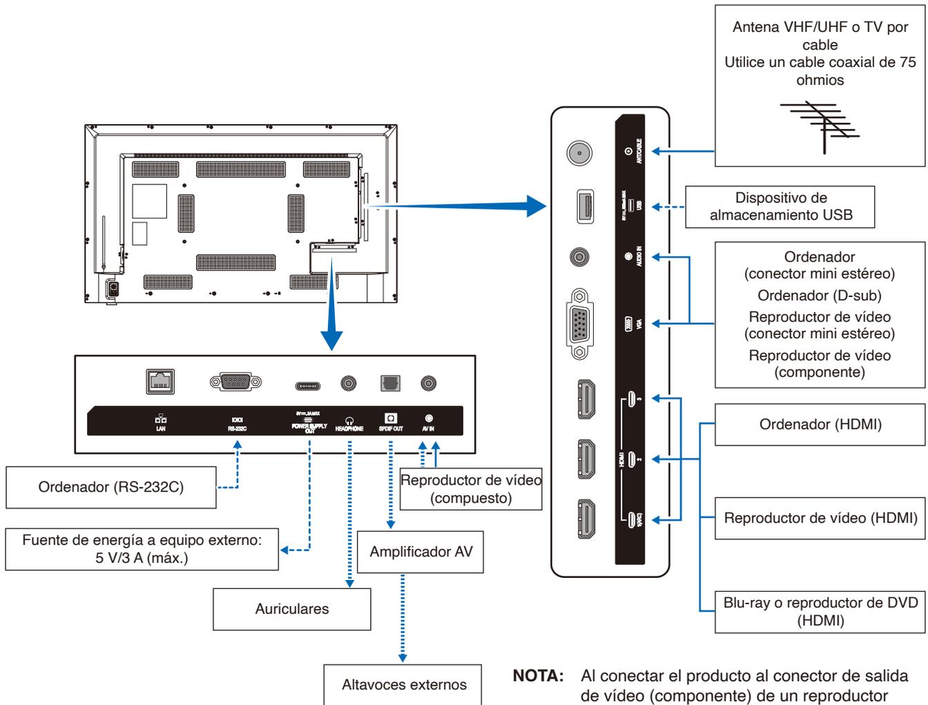
**NOTA:** Al conectar el producto al conector de salida de vídeo (componente) de un reproductor de vídeo u otro dispositivo, vaya a [Setup] (Configuración) en el menú OSD -> [VGA Options] (Opciones VGA) -> [VGA Mode] (Modo VGA) y seleccione [YPbPr] (YPbPr).
