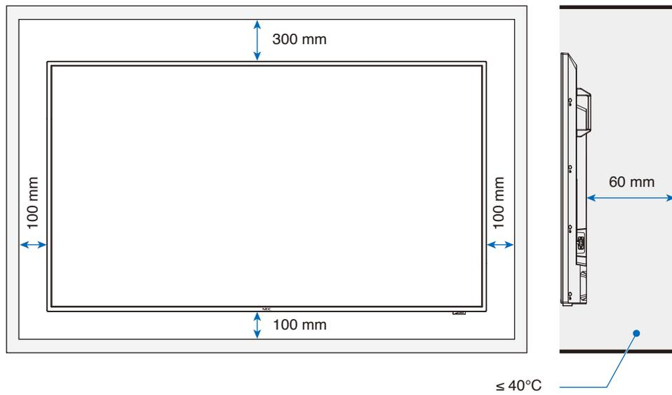
**NOTA:** La temperatura de funcionamiento máxima del entorno del monitor es 40 °C.
