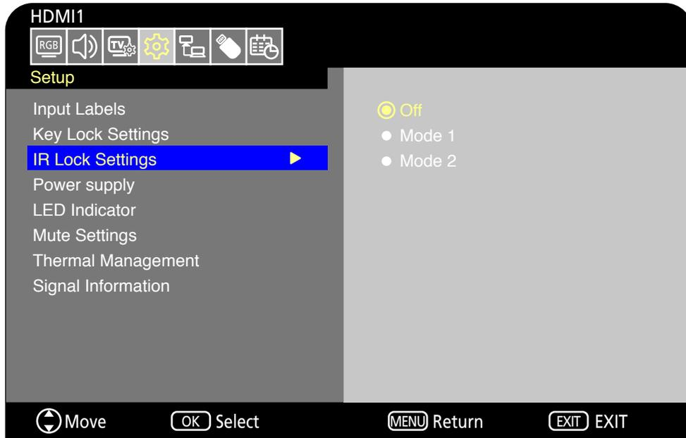
1. En el menú OSD, vaya a [Setup] (Configuración) -> [Other settings] (Otras configuraciones) y seleccione [IR Lock Settings] (Ajustes Bloqueo IR).
