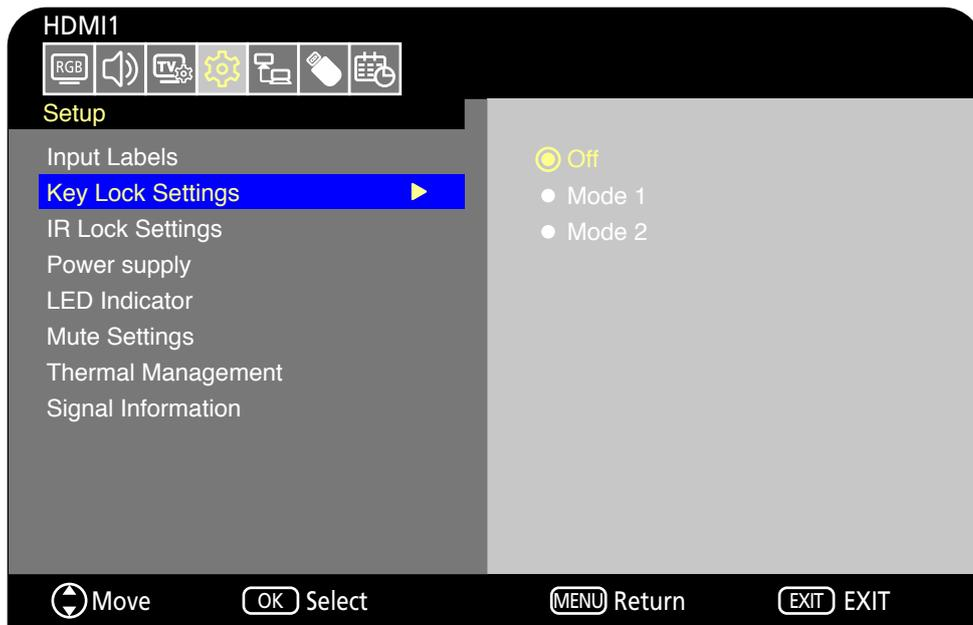
1. En el menú OSD, vaya a [Setup] (Configuración) -> [Other settings] (Otras configuraciones) y seleccione [Key Lock Settings] (Ajustes Bloqueo Tecla).
