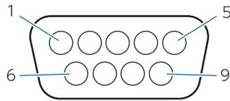
Este monitor utiliza líneas RXD, TXD y GND para el control de RS-232C.
