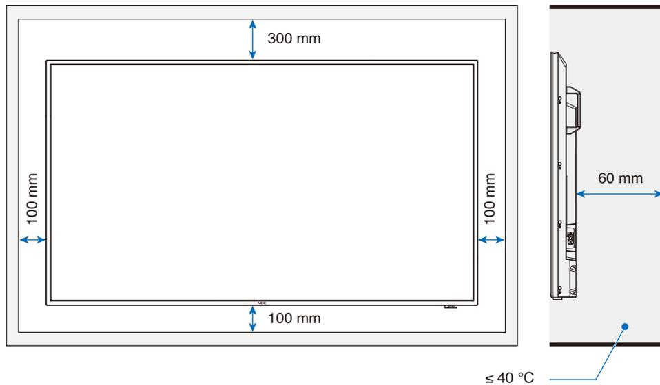
**REMARQUE :** La température environnementale maximale de fonctionnement du moniteur est de 40 °C. Le moniteur est équipé de capteurs de température interne.
