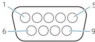
Ce moniteur utilise des lignes RXD, TXD et GND pour le contrôle RS-232C.
