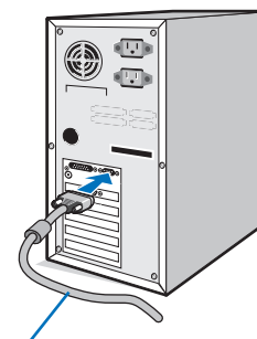
Signální kabel s 15kolíkovým konektorem mini D-Sub
