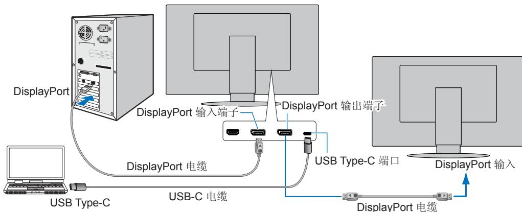
**提示:** • 当显示器没有图像时,请遵循故障排除步骤第 33 页的“从无图像中恢复”,并选择 DP VER [1.1]。
