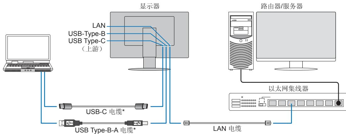
\* 通过 USB-C 电缆或 USB-Type-B - Type-A 电缆将显示器连接到计算机。
