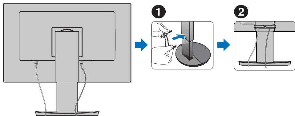
注意：安装电缆后，请检查是否仍然可以旋转、升高和降低显示器屏幕。
