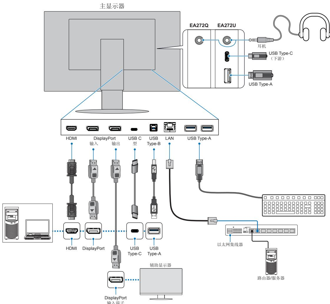
为遵守 EMC 法规，请使用屏蔽电缆连接到以下端子：USB 端口、USB Type-C 端口、HDMI 输入端子和 DisplayPort 输入端子。
