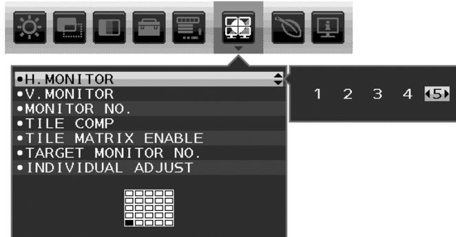
4. Pulse la tecla ABAJO/ARRIBA para seleccionar PANTALLAS V. Pulse la tecla IZQ./DERECHA para establecer PANTALLAS V 5.
