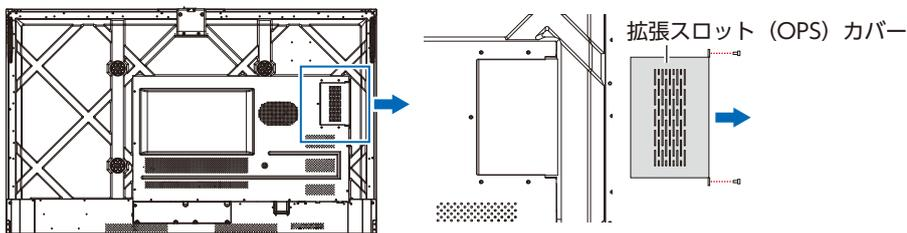
5. 拡張ボード (OPS) の上下を確認して本機にセットし、拡張スロット (OPS) カバーを固定していた M4 ネジ 2 本でボードを固定する。
