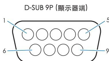
本顯示器使用 RXD、TXD 和 GND 線路進行 RS-232C 控制。
