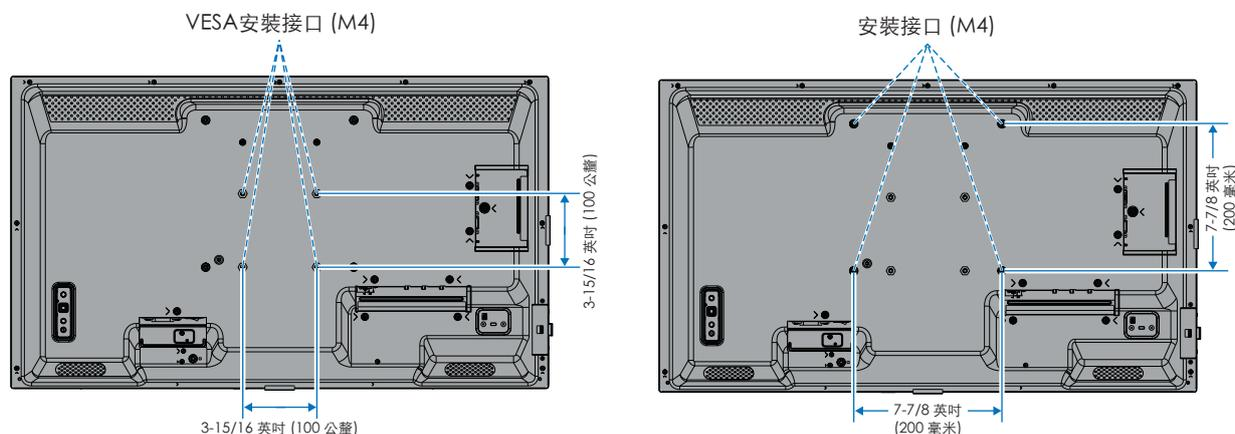
可以在顯示器正面朝下的情況下連接安裝配件。為了避免刮傷 LCD 面板，若要將顯示器面朝下放置於桌上，請務必墊一塊大於螢幕的軟布。確保桌子上沒有任何可能損壞顯示器的物品。
