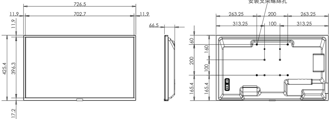
\* 安裝顯示器時，請務必使用符合 VESA 相容安裝方法的壁掛支架。
