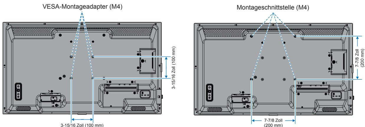
Montagezubehör kann an den Monitor angebracht werden, wenn dieser mit der Vorderseite nach unten liegt. Bevor Sie den Monitor mit der Vorderseite nach unten ablegen, legen Sie stets ein weiches Tuch auf den Tisch, z. B. eine Decke, die größer als der Monitor ist. So vermeiden Sie Kratzer auf dem LCD-Panel. Stellen Sie sicher, dass sich nichts auf dem Tisch befindet, was den Monitor beschädigen kann.
