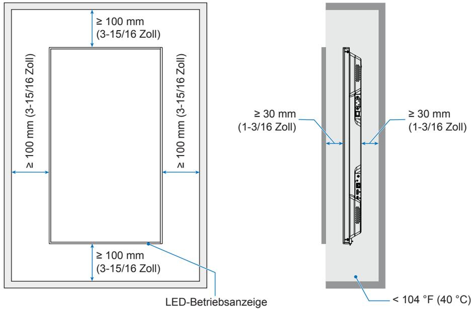
**HINWEIS:** Bei der Verwendung in einer Videowand über einen längeren Zeitraum können sich die Monitore aufgrund der Temperaturänderungen leicht ausdehnen. Es wird empfohlen, zwischen den Kanten von nebeneinander angeordneten Monitoren einen Abstand von mehr als einem Millimeter einzuhalten.
