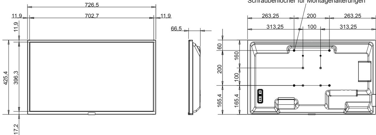
\* Vergewissern Sie sich bei der Montage des Monitors, eine Wandhalterung zu verwenden, die der VESA-kompatiblen Montagemethode entspricht.
