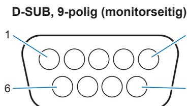
Dieser Monitor verwendet RXD-, TXD- und GND-Leitungen für die RS-232C-Steuerung.
