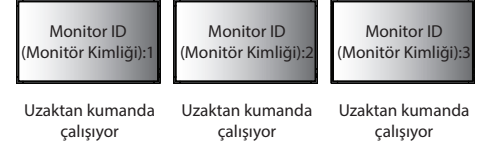
Şekil 1 Uzaktan Kumanda Normal modda veya REMOTE ID (Uzaktan Kumanda Kimliği) 0 olarak ayarlandı
