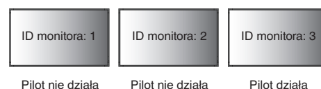
Rysunek 1 Pilot działa w trybie standardowym (Normal) lub opcja REMOTE ID (ID PILOTA) ustawiona na wartość 0
