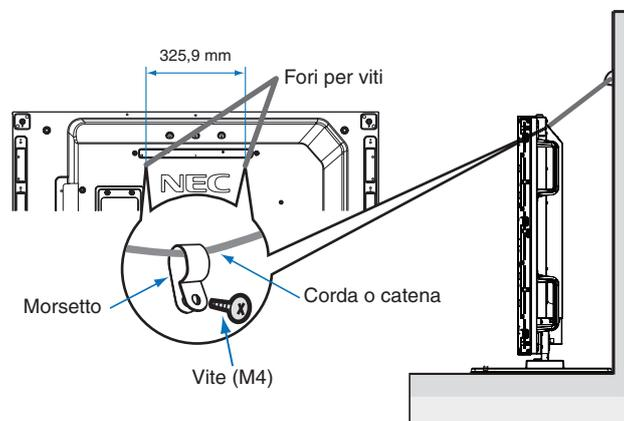
Prima di fissare il monitor alla parete, accertarsi che la parete sia in grado di sostenere il peso del monitor.
