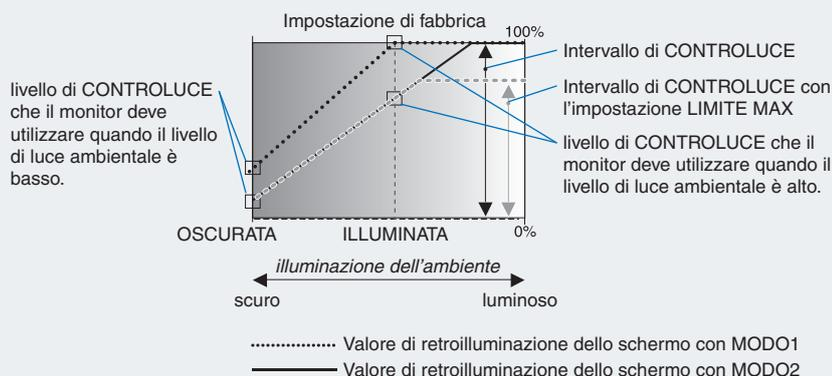
LIMITE MAX: il livello di CONTROLUCE è limitato al livello impostato.
