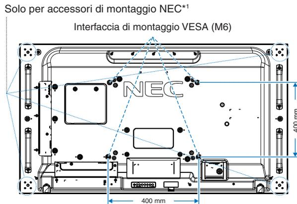
Gli accessori di montaggio possono essere fissati con il monitor rivolto in basso. Per evitare di graffiare il pannello LCD, posizionare sempre sul tavolo un panno morbido, come un telo più grande dell'area dello schermo del monitor, prima di collocare il monitor con lo schermo verso il basso. Accertarsi che sul tavolo non vi sia nulla che possa danneggiare il monitor.
