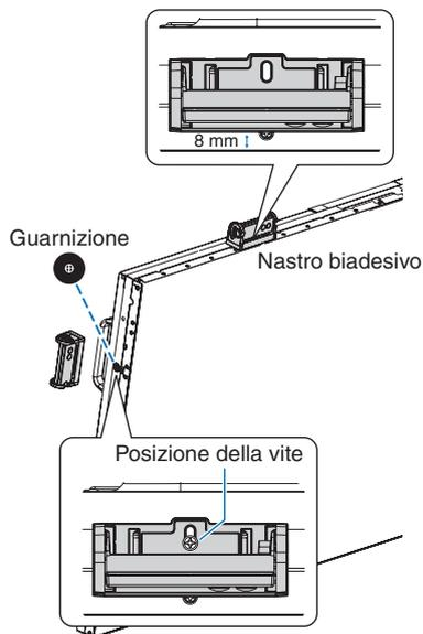
**Fissaggio mediante vite:** rimuovere la guarnizione che copre i fori delle viti sulla mascherina. Fissare l'unità con la vite. Posizionare l'unità sensore vicino al lato posteriore.
