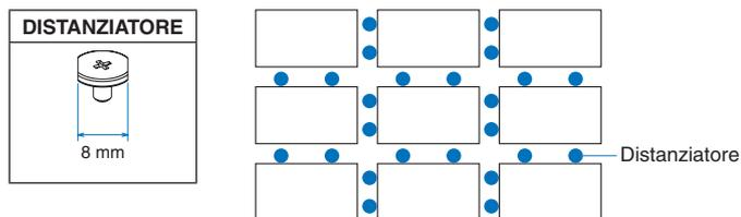
Ad esempio, installazione di un distanziatore nella configurazione di più monitor.
