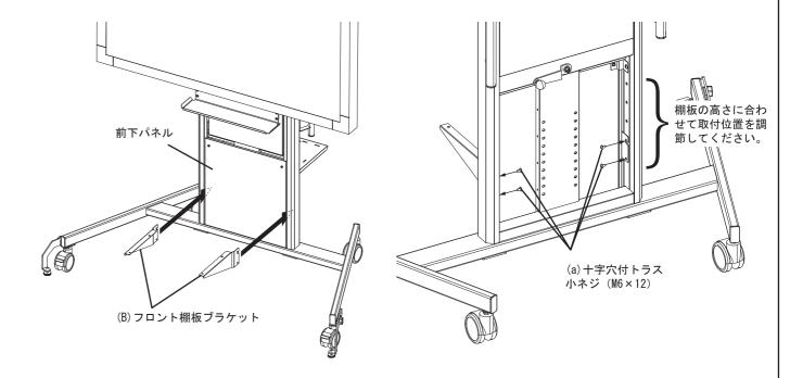
固定したブラケットに棚板を載せて下側から(a)十字穴付トラス小ネジ(M6×12)4本で固定します。
