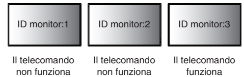
Figura 2 Telecomando impostato per utilizzare ID REMOTO:3
