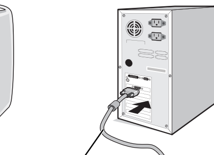
Signalkabel mit 15-poligem Mini-D-SUB-Stecker
