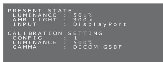
2. Wenn das OSD-Hauptmenü PRESENT STATE (AKTUELLER STATUS) angezeigt wird, halten Sie beide Tasten 2 Sekunden lang gedrückt. Das Untermenü SWITCHING CONFIGURATION (KONFIGURATION WECHSELN) wird angezeigt. Wenn die oben aufgeführten Bildschirme angezeigt werden, drücken Sie rasch die Netztaste (⏻). Das OSD-Untermenü wechselt erst zu SWITCHING INPUT SOURCE (EINGANGSQUELLE WECHSELN) und dann zu SWITCHING CONFIGURATION (KONFIGURATION WECHSELN).
