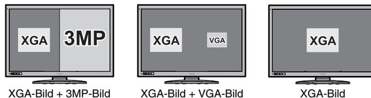
Neben zwei 3MP-Bildern und einem 6MP-Bild werden einige weitere Auflösungen unterstützt, die Anzeigeleistung kann jedoch nicht garantiert werden. Dies kann zu leichten Unterschieden bei der Luminanz und Farbe zwischen dem linken und rechten Bild oder zu übersprungenen Einzelbildern\* führen.
