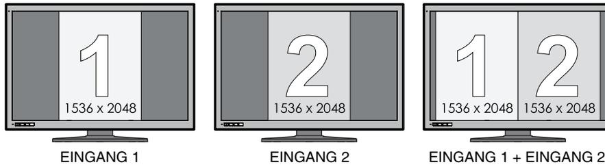
Im Folgenden wird ein Beispiel für eine Situation angezeigt, in der die Auflösung 3072 x 2048 für EINGANG 1 und QXGA (1536 x 2048) für EINGANG 2 ausgewählt ist.
