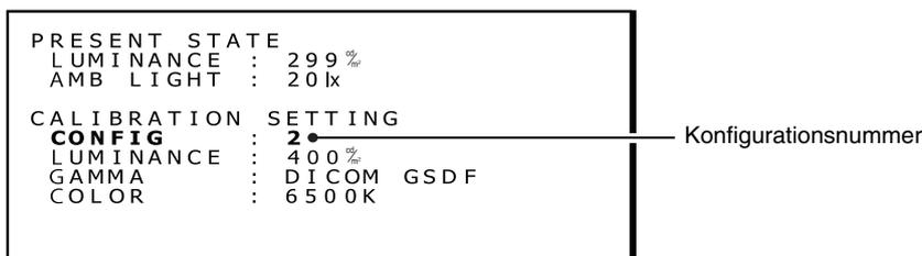
**HINWEIS:** Das OSD-Menü wird nach 15 Sekunden automatisch ausgeblendet.
