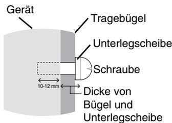
**HINWEIS:** Ziehen Sie alle Schrauben fest. (empfohlene Befestigungskraft: 98 – 137 N•cm)
