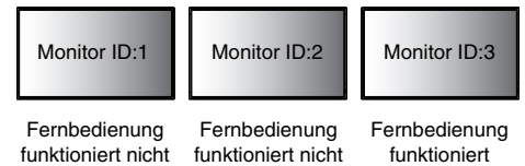
Abbildung 2 Auf der Fernbedienung ist die FERNBEDIENUNGS-ID: 3 eingestellt.
