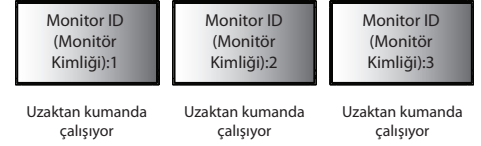
Şekil 1 Normal modda uzaktan kumanda veya REMOTE ID (Uzaktan Kumanda Kimliği) 0'a ayarlandı.
