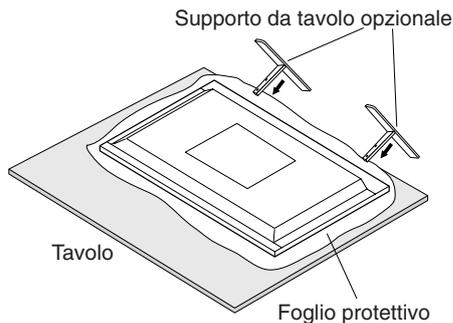
**NOTA:** Montare il supporto nella direzione della freccia che è stampata sulla superficie del supporto. Utilizzare ST-322 per il modello V323-3.
