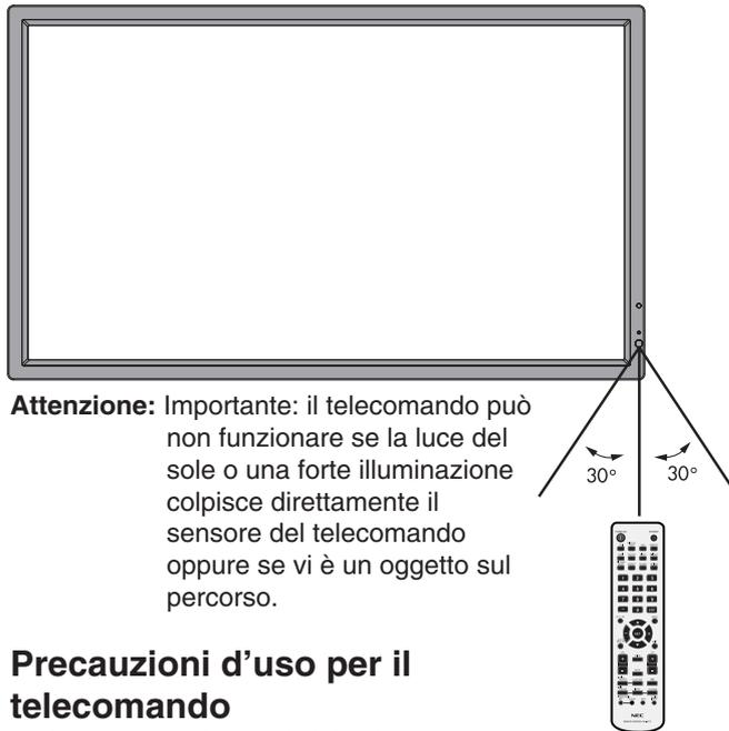
**Attenzione:** Importante: il telecomando può non funzionare se la luce del sole o una forte illuminazione colpisce direttamente il sensore del telecomando oppure se vi è un oggetto sul percorso.
