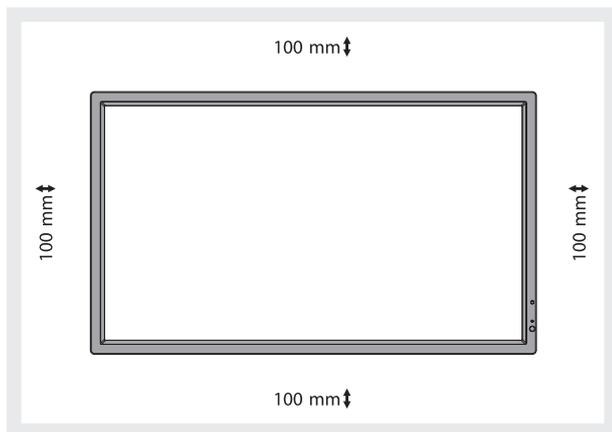
Prevedere un'adeguata ventilazione o il condizionamento dell'aria intorno al monitor in modo tale da dissipare il calore dall'unità e dalla struttura di montaggio, soprattutto quando si usano più monitor affiancati.
