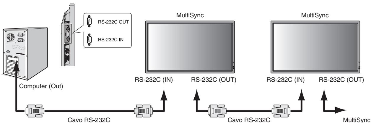
**NOTA:** Se il computer è equipaggiato solo con un connettore a porta seriale a 25 pin, è necessario un adattatore per porta seriale a 25 pin. Contattare il fornitore per i dettagli. Selezionare l'opzione "ID=ALL REPLY" in "COMANDO ESTERNO".
