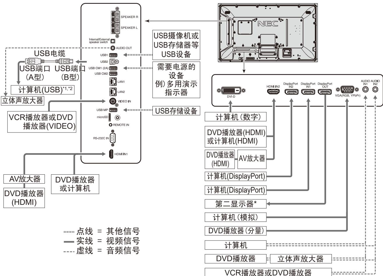
\*: 以菊花链连接的多台显示器对于可连接显示器的台数有限制。
