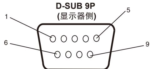
此液晶显示器使用 RXD、TXD 和 GND 线以进行 RS-232C 控制。
