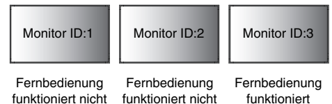
Abbildung 2 Auf der Fernbedienung ist die FERNBEDIENUNGS-ID: 3 eingestellt.
