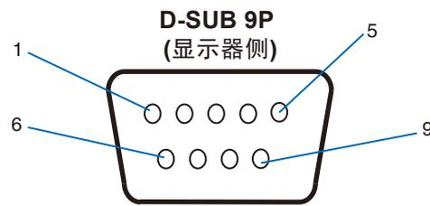
此显示器使用 RXD、TXD 和 GND 线以进行 RS-232C 控制。
