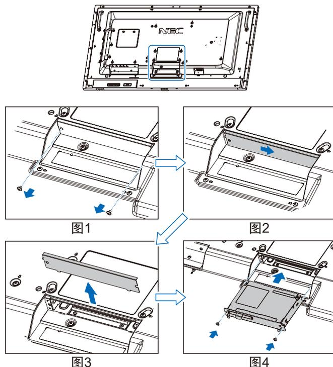
4. 将选配板卡插入显示器并用拆下的螺丝固定 (图 4)。
