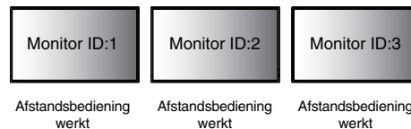
Illustratie 1 Afstandsbediening in normale modus of de REMOTE ID is ingesteld op 0
