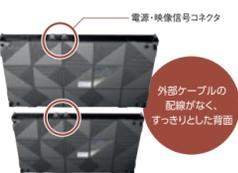
\*FEシリーズのコネクタ接続は、電源供給のみです。映像信号は、キャビネットの上下ホール部分からLANケーブルを通して接続します。
