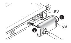
盗難防止のため、microSDメモリーカードを 挿入したあとは、●カバーのツメをスロットの 横のミゾに引っかけて、②ネジを締めます。
