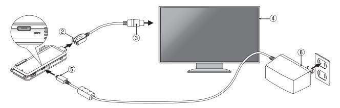
② 添付の HDMI 延長ケーブルの一方の端を本機の HDMI コネクターに接続します。
