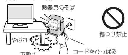
重いものをのせたり、熱器具に近づけたり、無理に引っ張ったり、折り曲げたまま力を加えたりしないこと。コードが破損して火災・感電の原因になります。
