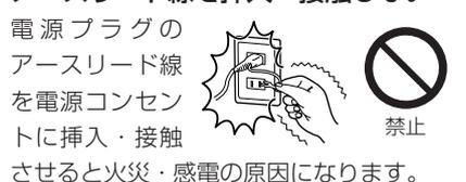
電源プラグのアースリード線を電源コンセントに挿入・接触させると火災・感電の原因になります。
