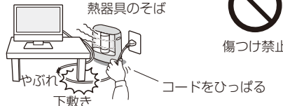
熱器具のそば コードをひっぱる 下敷き 重いものをのせたり、熱器具に近づけたり、無理に引っ張ったり、折り曲げたまま力を加えたりしないこと。コードが破損して火災・感電の原因となります。
