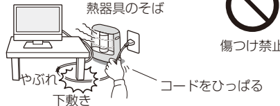
熱器具のそば コードをひっぱる 下敷き 重いものをのせたり、熱器具に近づけたり、無理に引っ張ったり、折り曲げたまま力を加えたりしないこと。コードが破損して火災・感電の原因になります。
