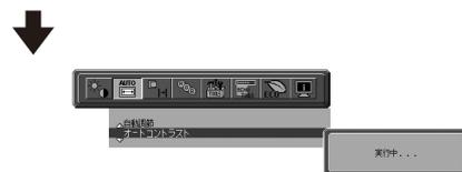
「実行中…」の表示が消え、元の画面が表示されたらコントラストの自動調節は完了です。
