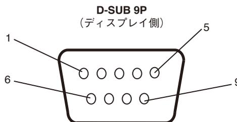
ディスプレイはRS-232Cの制御にRXD, TXD, GNDを使用します。
