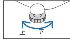
旋转镜头移动刻度盘 (垂直移动)
