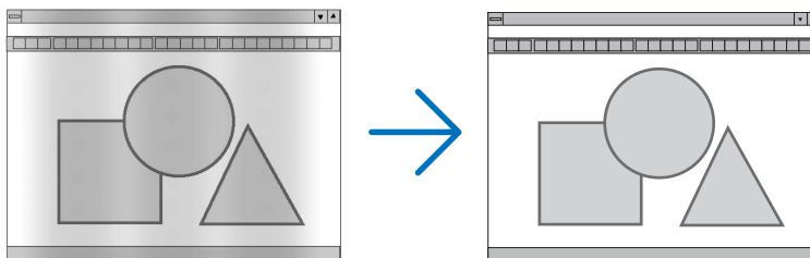
**时钟频率** ..... 使用此项功能可微调电脑影像或去除可能出现的垂直条纹。此功能可通过调整时钟频率来去除影像上的水平条纹。
