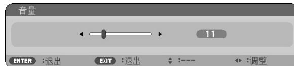
提示：无菜单出现时，投影机机箱上的  $\triangle$  和  $\square$  键作为音量控制使用。
