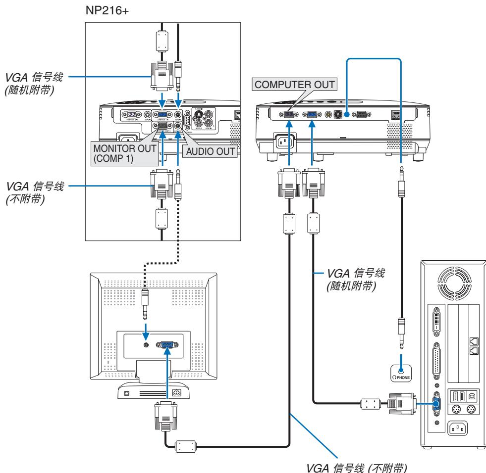
您可以单独连接一个外部控制器到您的投影机，此举可在控制器上同步显示您正在投射的电脑模拟影像。
