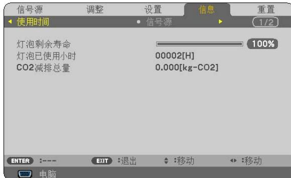
[CO<sub>2</sub> 减排量] 表示从开机后即切换为节能模式到关机时止的 CO<sub>2</sub> 减排量。[CO<sub>2</sub> 减排量] 将在关机时出现的 [关机/确定？] 信息中显示。
