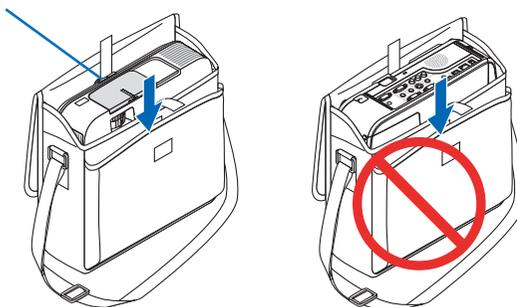
**ПРИМЕЧАНИЕ:** Перед тем, как ставить проектор в мягкий футляр, сложите ножку для регулирования наклона и заднюю ножку. В противном случае проектор может повредиться.
