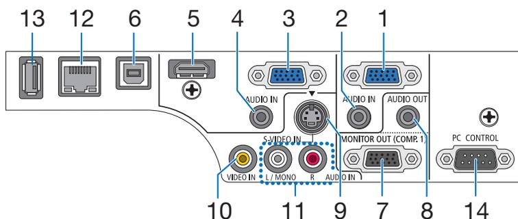
1. **COMPUTER 1 IN/ Компонентный входной разъем (Mini D-Sub 15 Pin)** (→ стр. 104, 108)
