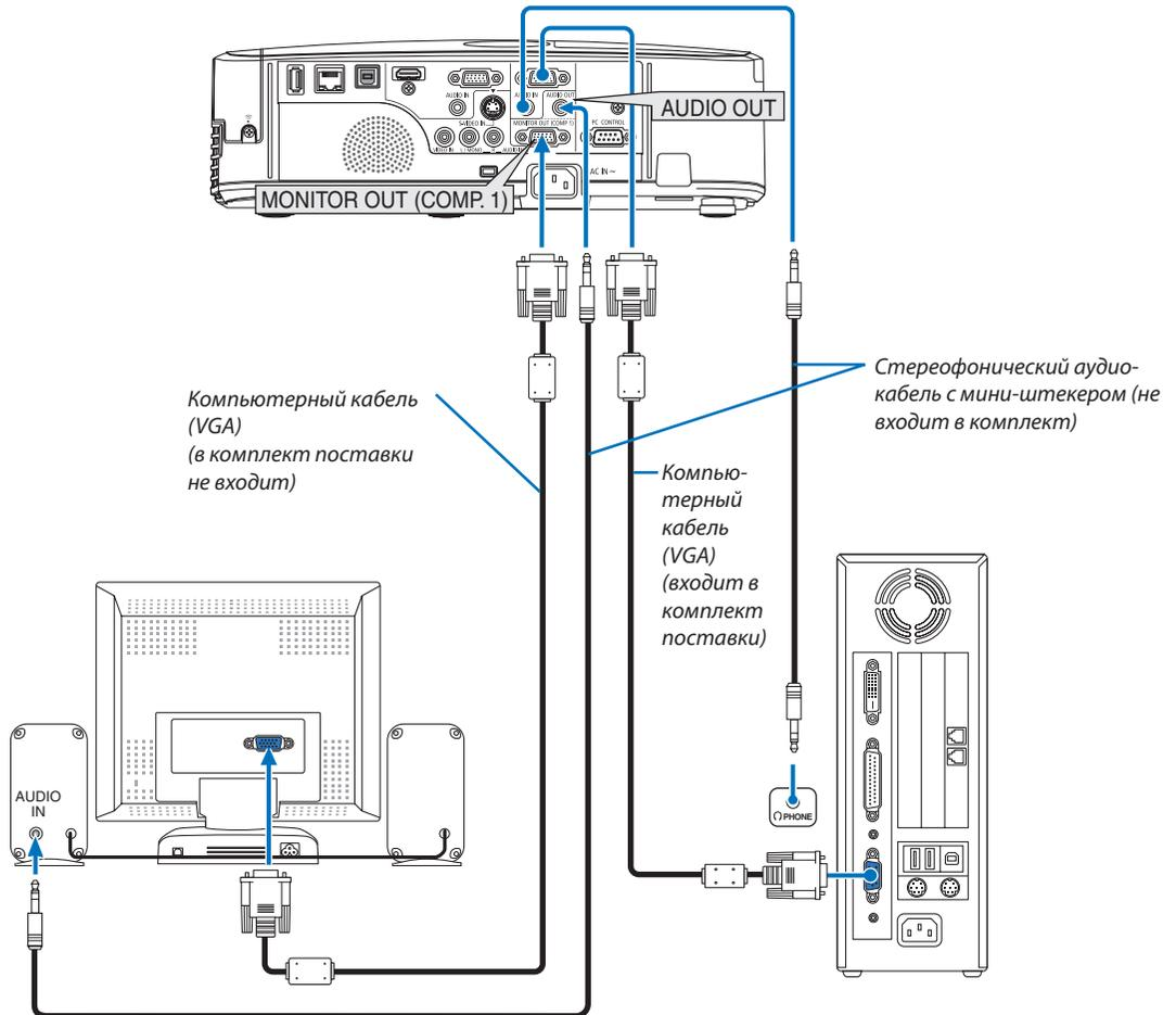
К проектору можно подключить отдельный внешний монитор для параллельного просмотра на мониторе проецируемого компьютерного аналогового изображения.
