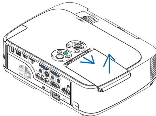
**2. Снимите корпус лампы.**
