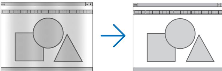
**RELOJ**..... Utilice esta opción para ajustar con precisión la imagen del ordenador o para eliminar eventuales franjas verticales. Esta función ajusta las frecuencias del reloj que eliminan las bandas horizontales que aparecen en la imagen.
