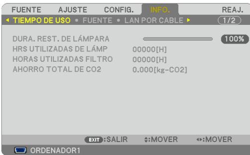
El mensaje [SESIÓN-AHORRO DE CO2] muestra la cantidad de la reducción de la emisión de CO<sub>2</sub> entre el cambio a MODO ECO inmediatamente después de la activación y desactivación de la energía. Se visualizará el mensaje [SESIÓN-AHORRO DE CO2] en el mensaje [ALIMENTACIÓN DESACTIVADA / ¿ESTÁ USTED SEGURO?] en el momento de la desactivación de la energía.
