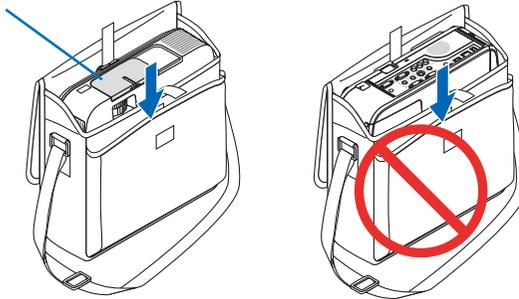
**NOTA:** Cuando coloque el proyector en el estuche blando, retire la pata de inclinación y las patas traseras. El no hacer esto podría causar daño al proyector.
