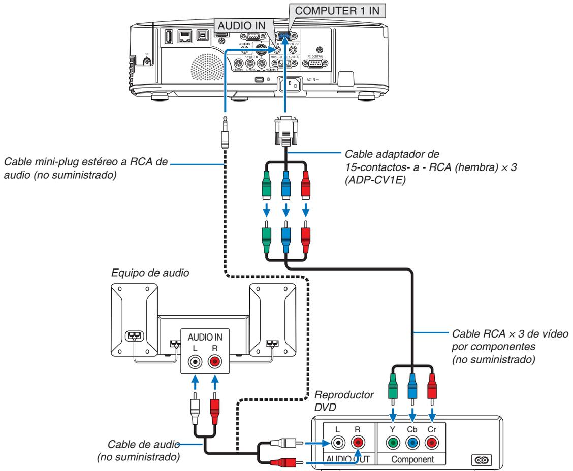
Se mostrará automáticamente una señal de componente. Si no es así, seleccione [CONFIG.] → [OPCIONES(1)] → [SELECCIONAR SEÑAL] → [ORDENADOR1] o [ORDENADOR2] del menú, y a continuación maque la opción en el botón de componente de radio.
