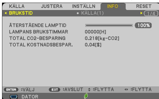
Meddelandet [CO2-BESPARINGSSESSION] visar mängden CO<sub>2</sub>-utsläppsminskning från när växlingen till EKO-LÄGE gjordes direkt efter starten fram till strömmen stängdes av. Meddelandet [CO2-BESPARINGSSESSION] visas i meddelandet [AVSTÄNGNING / ÄR DU SÄKER?] när strömmen stängs av.
