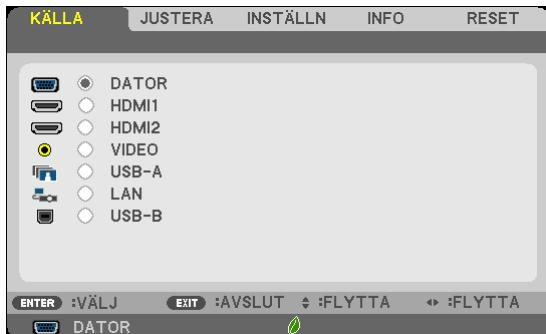
*OBSERVERA: Kommandon som ENTER, EXIT, ▲▼, ◀▶ längst ner visar de tangenterna som kan användas.*
