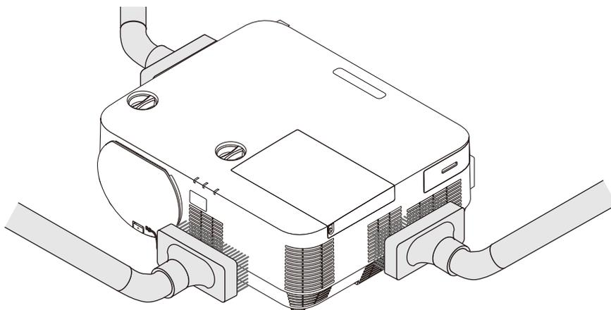
抽吸散热孔中的灰尘。
