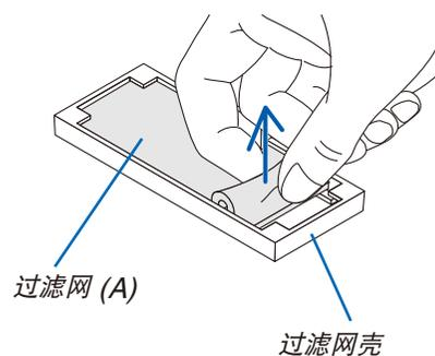
4. 抽吸过滤网 (A) 和过滤网壳上的所有灰尘。
