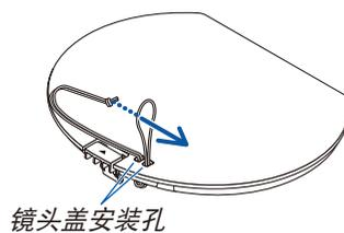
2. 将绳结插入投影机底部的吊带安装孔 (大)，然后将其按入窄孔 (小)。
