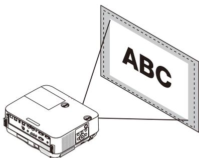
调整投射影像的高度和水平倾斜
