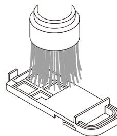
(3) 将一张新的过滤网 (B) 固定在过滤网壳上。
