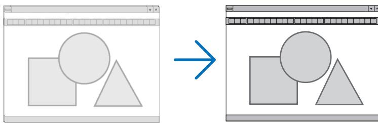
**ΦΑΣΗ** .....Χρησιμοποιείτε αυτό το στοιχείο για να ρυθμίζετε τη φάση του ρολογιού για να μειώνετε το θόρυβο του βίντεο, τις κουκκίδες («χιόνια») ή τις παρεμβολές σημάτων. (Αυτό ισχύει όταν τημήμα της εικόνας σας εμφανίζεται να τρεμοπαίζει.)
