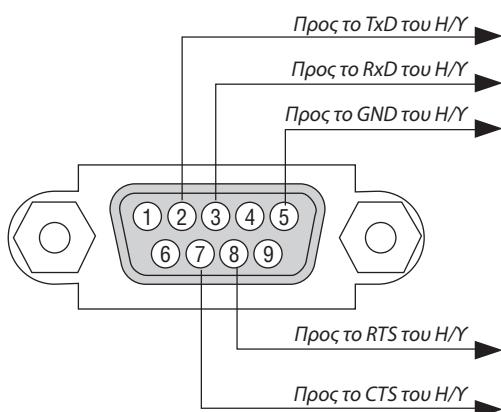
**ΣΗΜΕΙΩΣΗ 1:** Οι ακίδες 1, 4, 6 και 9 δεν χρησιμοποιούνται.
