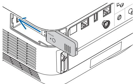
**4. Τοποθετήστε το κάλυμμα ασύρματου LAN.**
