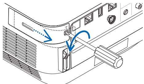
3. Τοποθετήστε τη μονάδα Ασύρματου LAN στη θύρα USB (Ασύρματο LAN).
