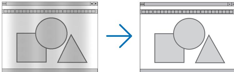
**ΡΟΛΟΪ**.....Χρησιμοποιήστε αυτό το στοιχείο για να ρυθμίσετε την εικόνα του υπολογιστή ή να αφαιρέσετε τυχόν κάθετες λωρίδες που μπορεί να εμφανίζονται. Η λειτουργία αυτή ρυθμίζει τις συχνότητες του ρολογιού που μειώνουν τις οριζόντιες λωρίδες της εικόνας.
